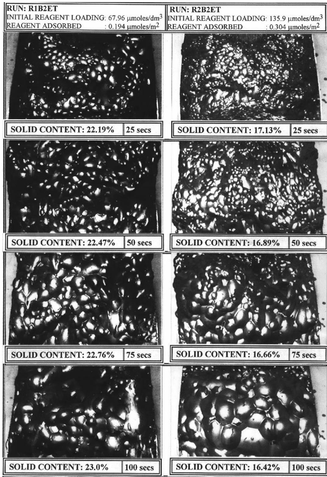
Şekil 13. Farklı flotasyon sürelerinde belirlenen froth görüntüleri
