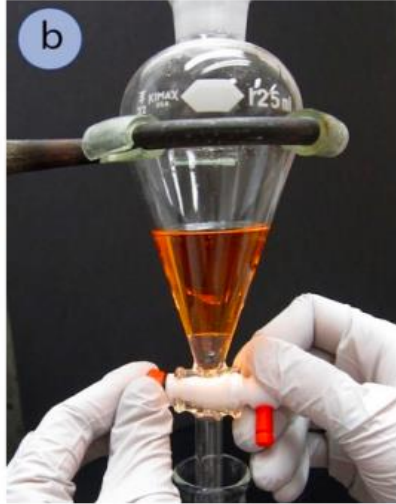
b) Organik fazın sulu fazdan kurtarılması sulu faz tam musluk hizasına gelip gözden kaybolunca, musluk kapatılır.
