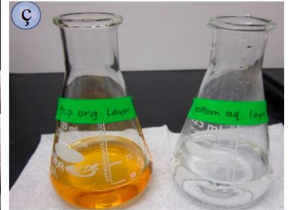
ç) Organik ve sulu fazların ayrıldığı kaplar etiketlenir. Organik faz, kurutucu üzerinde kurutulduktan sonra damıtılarak saflaştırılır.
