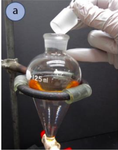
a) Ayırma hunisinin bir spora sabitlenmesi ve kapağın açılması, fazların ayrılması için beklenmesi.
