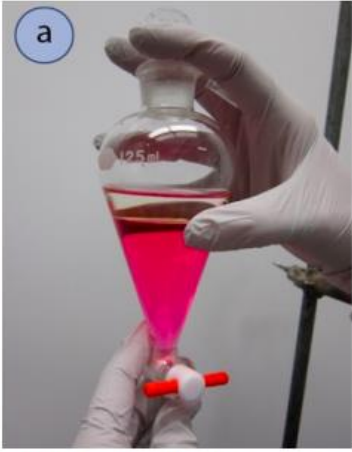
a) Çalkalama öncesinde ayırma hunisi şekildeki gibi tutulur
