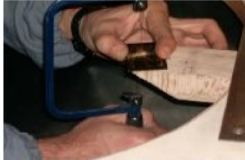
Resim 2.9: Kesim sırasında parçanın tutulması
