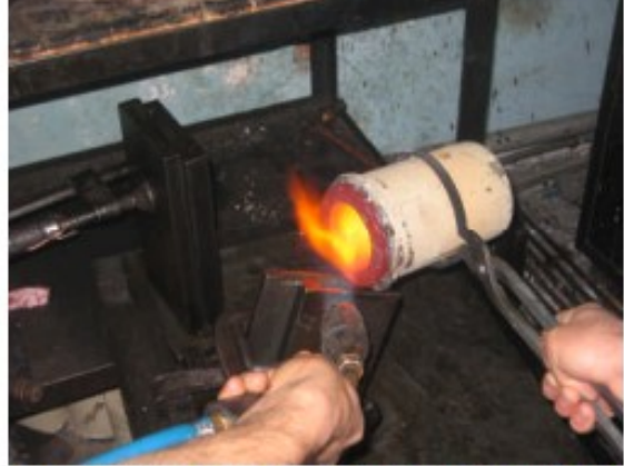
Resim 2.10: Eriyen metalin şideye dökülmesi
