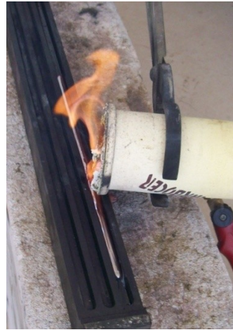
Fotoğraf 3: Savatın çubuk kalıba dökülmesi(2010)
