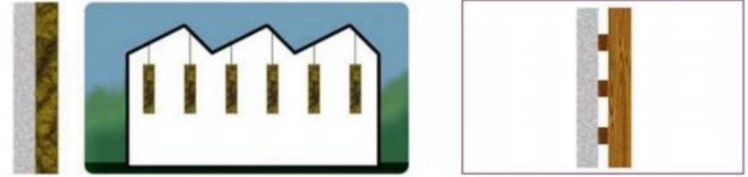
Şekil 2.7. Perdeler (solda) ve diyaframlar (sağda) [23]
