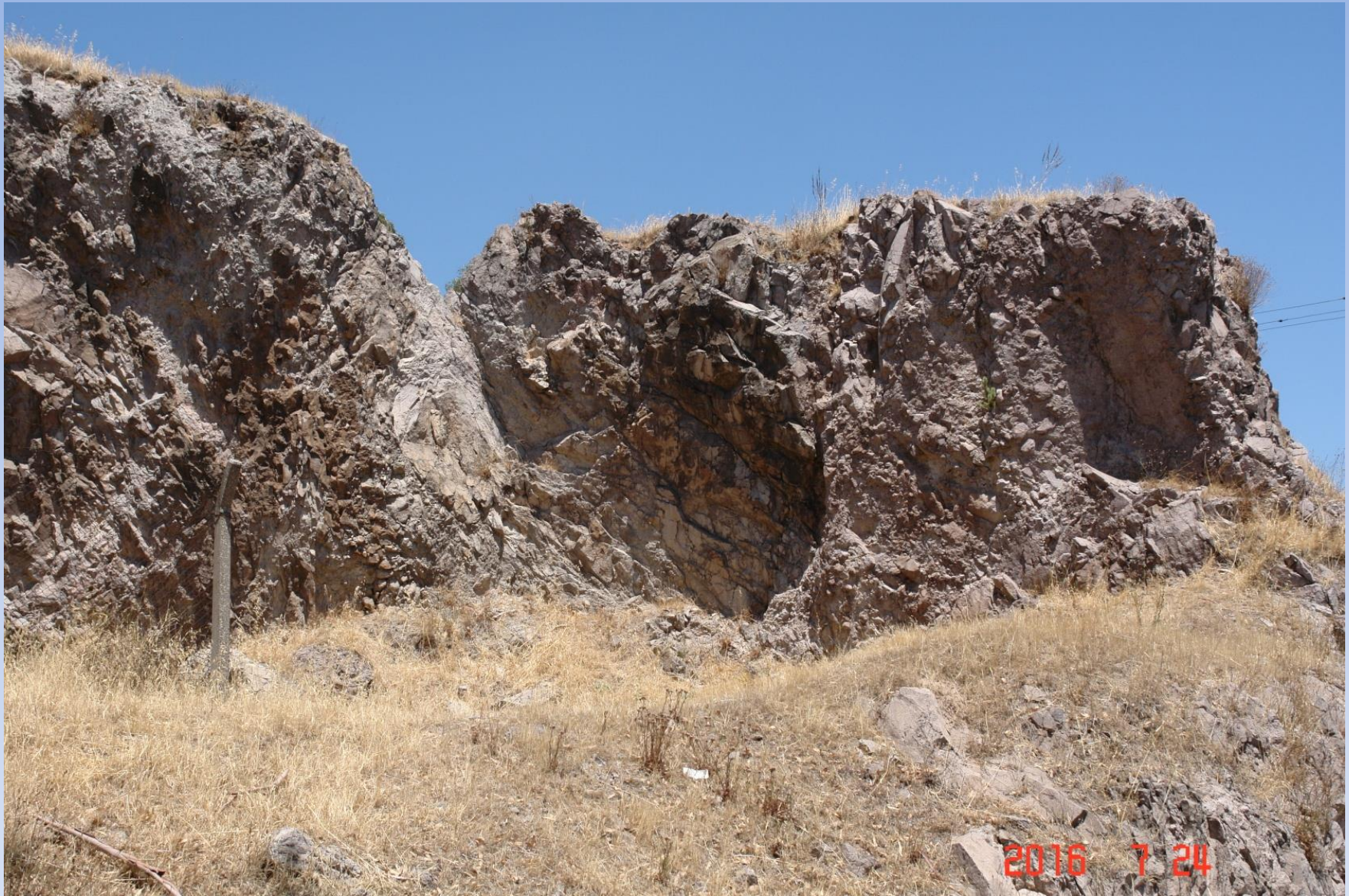
İzmir, Bayraklı Miyosen Andezit-Aglomera İçinde Farklı Derecede Ayrışma/Bozunma
