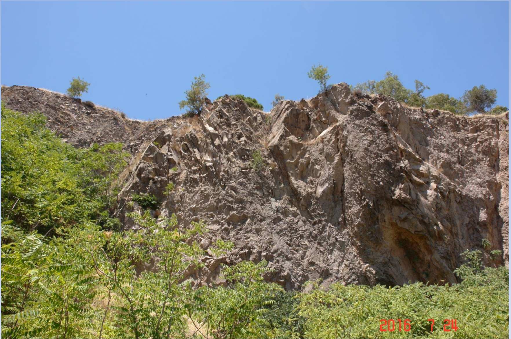
İzmir, Bayraklı Miyosen Andezit-Aglomera. Aynı Kaya Kütlesi İçindeki Farklı Yönelimlere Sahip Süreksizlikler
