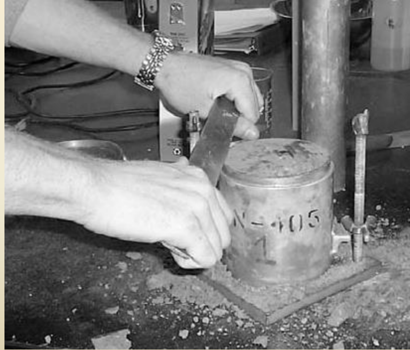
Kalıpta sıkıştırılmış örnek
