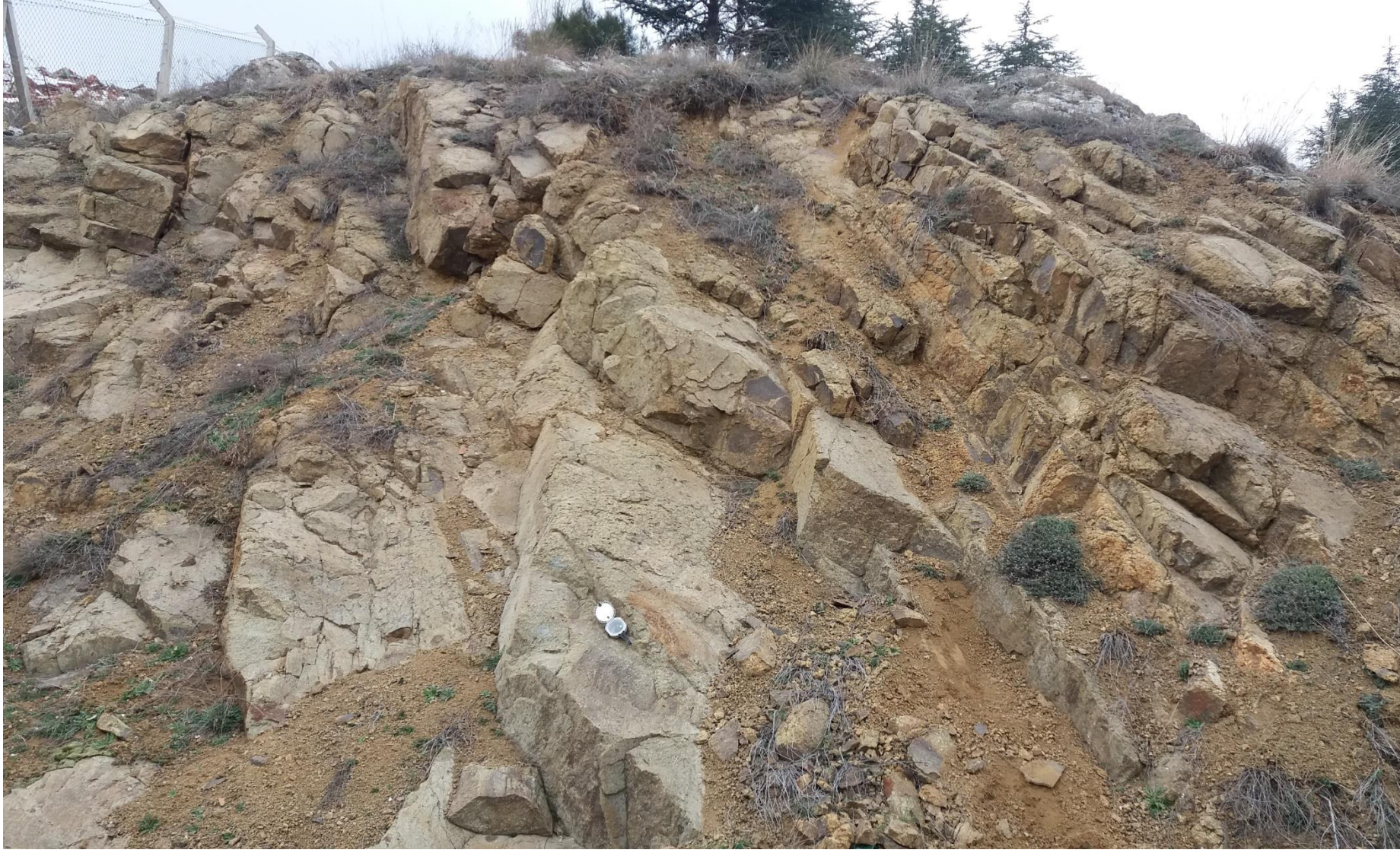
Altındağ, Cindersi Andezit Kütlesi İçinde Şeve Paralel Düzlemler
