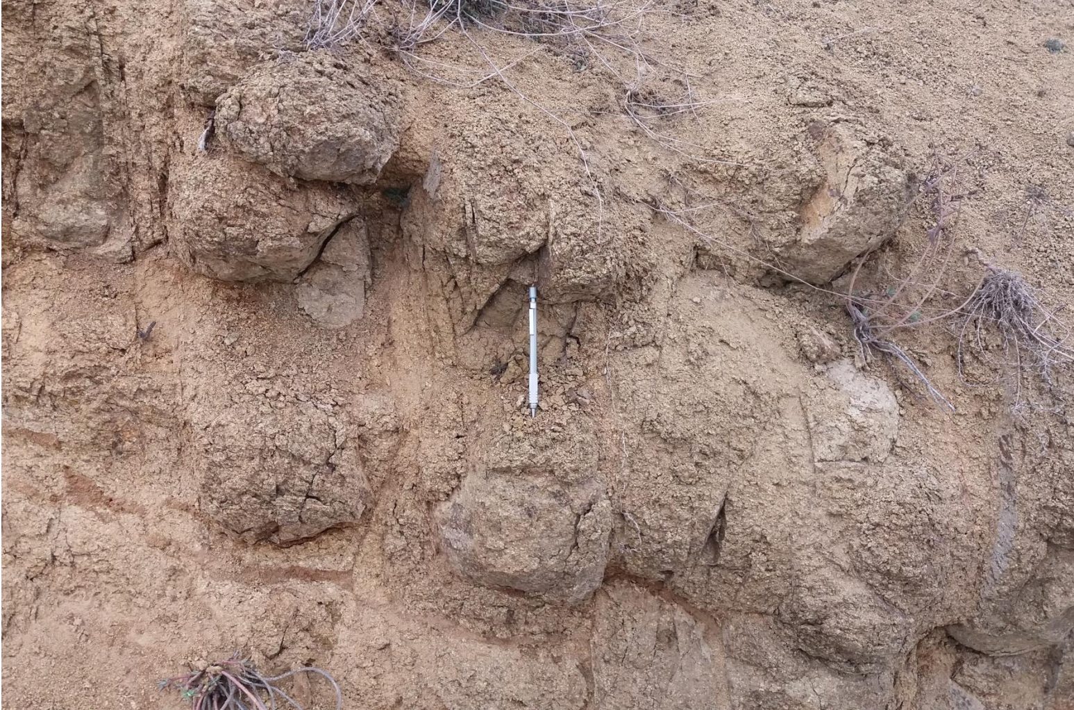
Altındağ, Cindersi Andezitler İçinde Ayrışma/Bozunma Görülen Kesimler
