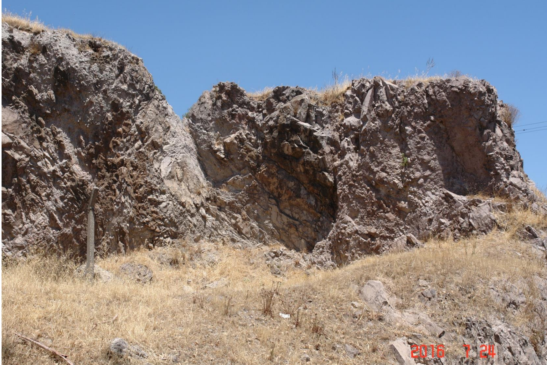
İzmir, Bayraklı Andezit-Aglomera Kütlesinde Farklı Yönelimdeki Süreksizlikler ile Makaslama
