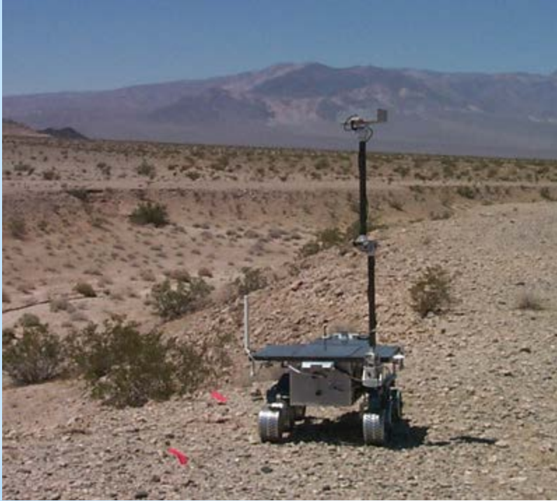
Spirit ve Opportunity araçlarının bir prototipinin zorlu arazi koşullarında test edilmesi (Ağustos 2002)
