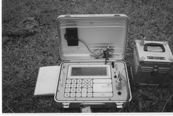
Şekil 11. SIROTEM TEM aygıtı ve güç kaynağı
