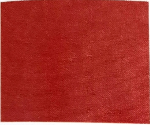
Ne 20/1 Karde pamuk ipliğinden dokunarak boyanmış kumaş
