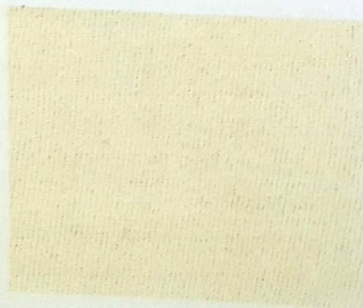
Karde triko pamuk ipliğinden üretilmiş kumaş örneği
