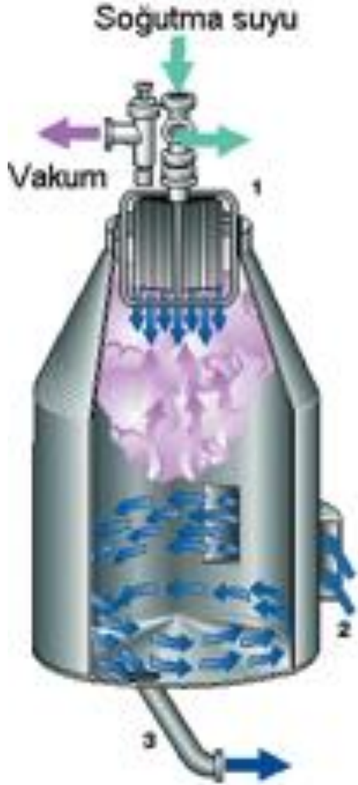
1 Kondenser 2 Süt girişi 3 Seviye kontrol sistemli süt çıkışı
