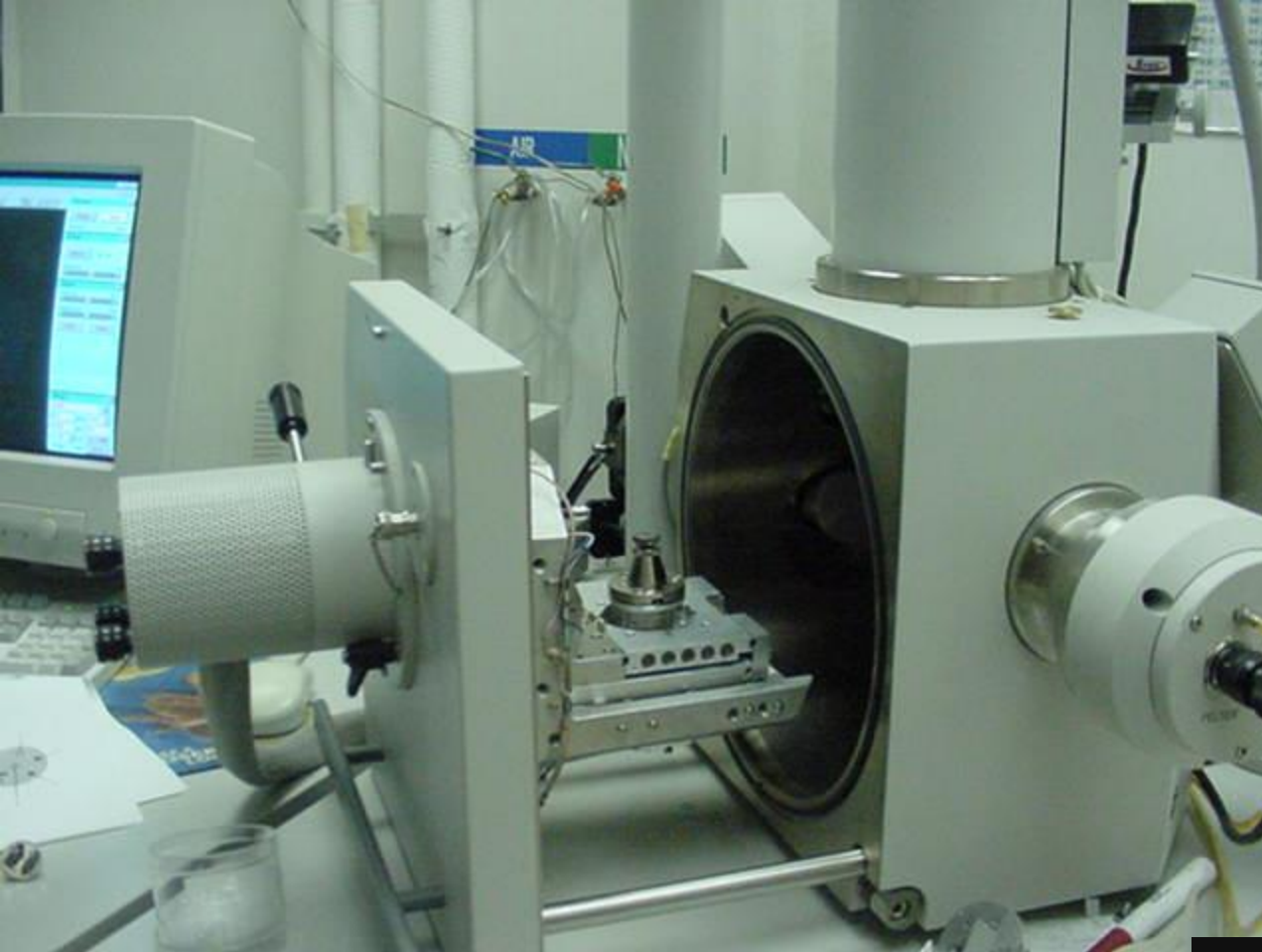
Taramalı Elektron Mikroskobunun vakum odasının görüntüsü
