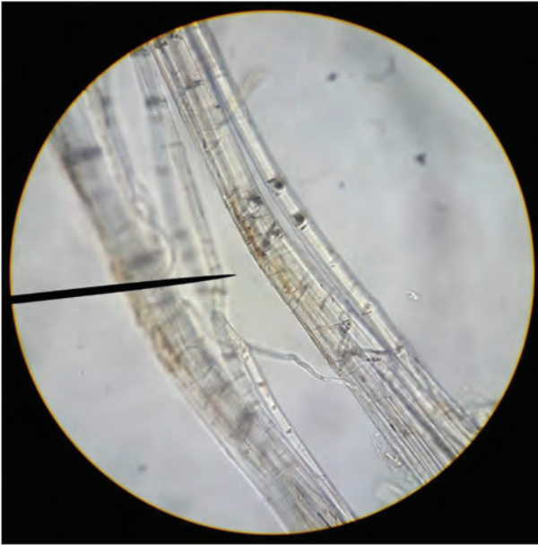
Şekil 4. YZE6948-2(E) envanter numaralı eserin lif görüntüsü (Keten lifinin boyuna görünüşü) (Işık mikroskobu).
