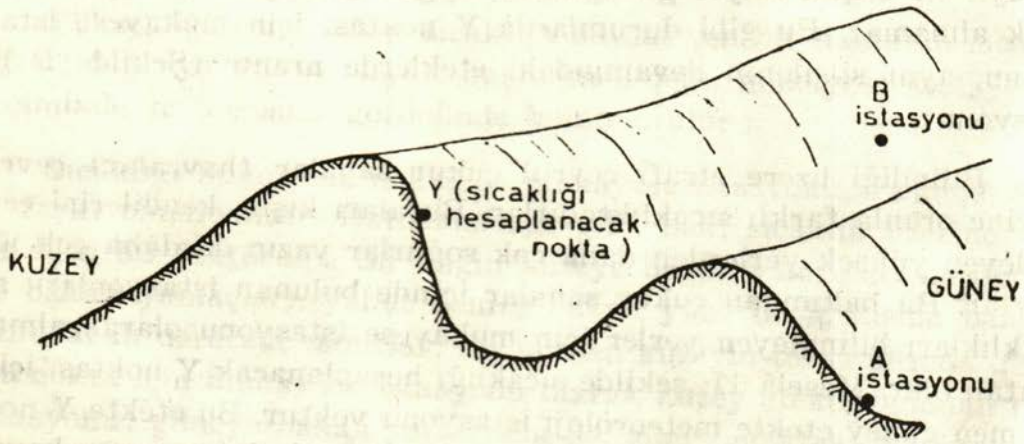
10. Şekil — Bu şekildeki Y noktası için, aynı bakıda bulunmasına rağmen, A istasyonu uygun bir mukayese istasyonu değildir; çünkü ikisi arasında bir başka rölyef girmektedir. Bu takdirde Y noktası için uygun mukayese istasyonu, aynı silsilenin devamındaki B istasyonudur.
