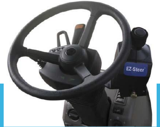
Elektrik motoru ile direksiyon kontrolü
