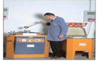
(5) Mandrellerin santrifüj dökümü. Solda: Kalıbın döndürülmesi esnasında düşük sıcaklıkta eriyen alaşımın dökümü. Sağda : Donmuş alaşım için pota.
