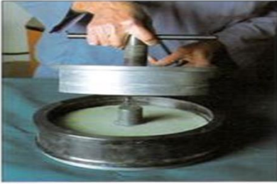
(2) İki silikon tabaka arasında bulunan kalıplar pişirme (vulkanizasyon) için çelik bir silindirin içine yerleştirilir.
