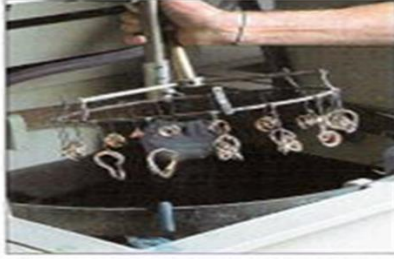
(8) Yüzey görünümlerini mükemmelleştirmek ve elektroform yapılmış altını düşük sıcaklıkta eniyen alışımdan ayırmak için parlak elektrolitik bakır kaplaması (Zamankı yapılmış modellerde gerekli değil).
