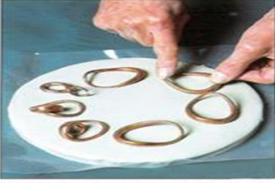
(1) Silikon kalıp üretimi için kılavuzların yerleştirilmesi
