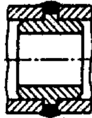
Ara parçanın dış çapı biraz küçük yapılarak kaynak ağzı oluşturulmuş.
