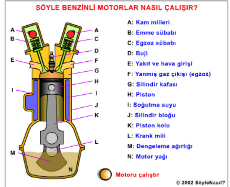
Bir benzinli araba motorunun kesiti ve çalışma prensibi
