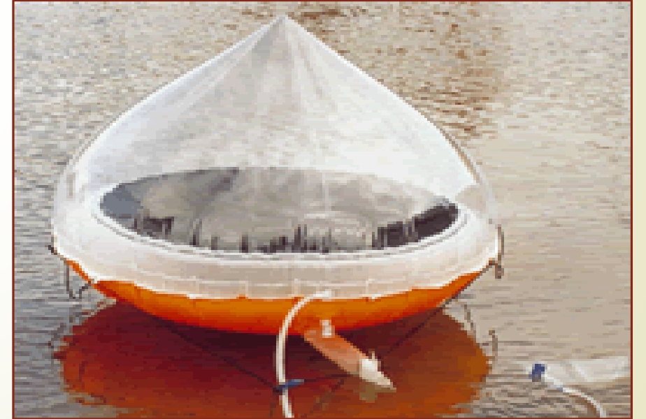
Şekil 4.17 Basit sera tipi güneş enerjili damıtma sistemi (Anonim 2009b, http://cevre.alternaturk.org/gunesle-su-aritma/ )
