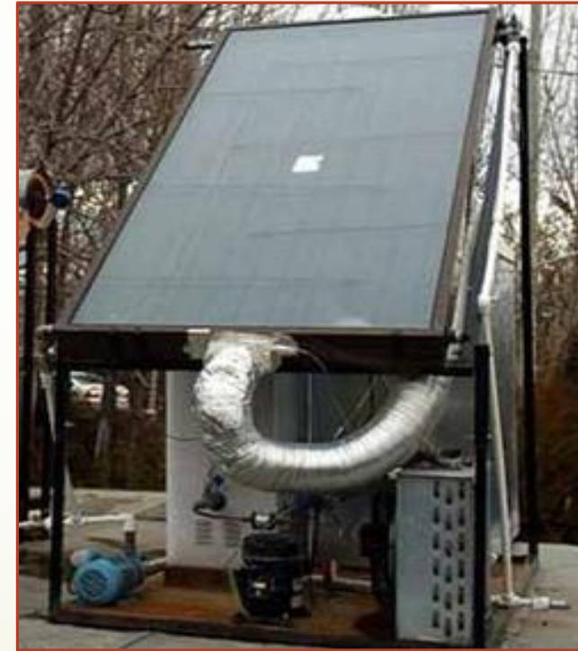
Şekil 4.20 Güneş enerjili absorpsiyonlu soğutma sistemi (Anonim 2009b, http://www.alternaturk.org/gunes-enerjisi-sogutma.php )
