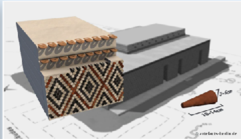
Detail einer Anmation, die den konstruktiven Aufbau der Mosaikfassade des sogenannten Steinsitzgebäudes in Luuk erklärt. Die Wanddekoration dieses einzigartigen Gebäudes setzt sich aus Hunderttausenden farbiger Steinsäfte zusammen. Auftraggeber: Prof. Ricardo Eichmann, Orient-Abteilung, Deutsches Archäologisches Institut, Berlin.
