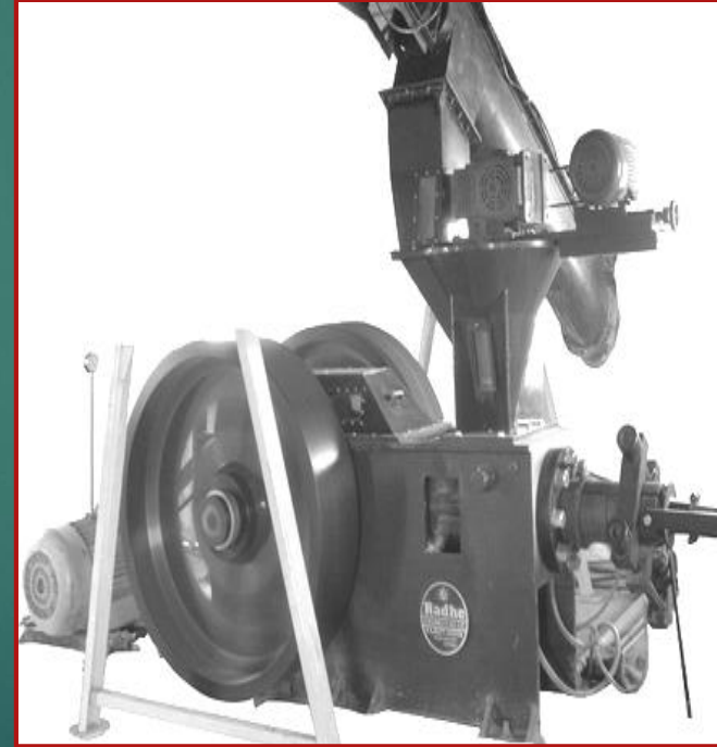
Şekil 10.16 Mekanik (a) ve hidrolik (b) piston presli briketleme makinesi (Karaca, 2009)
