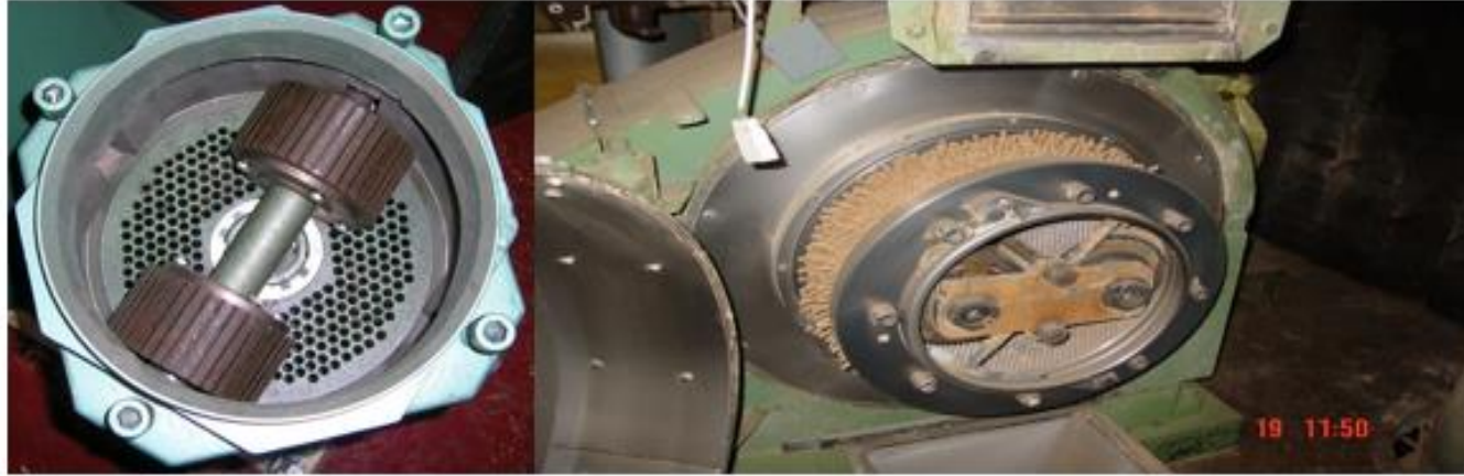
Şekil 10.12 Düz kalıplı (a) ve çember kalıplı (b) peletleme teknolojisi (Karaca, 2009)
