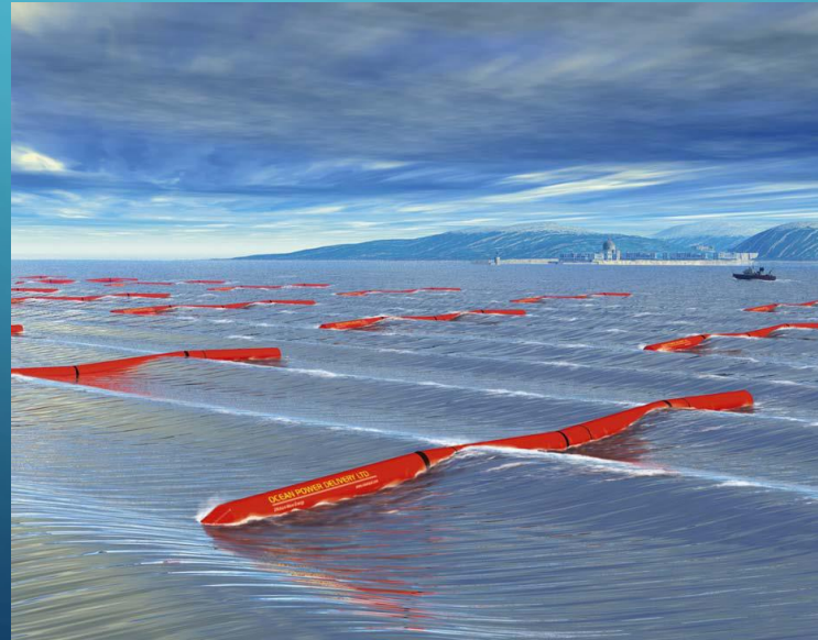
Şekil 8.4 Pelamis ve Pelamis enerji dönüşüm çiftliği simülasyonu (Henderson, 2005; Mert, 2012)
