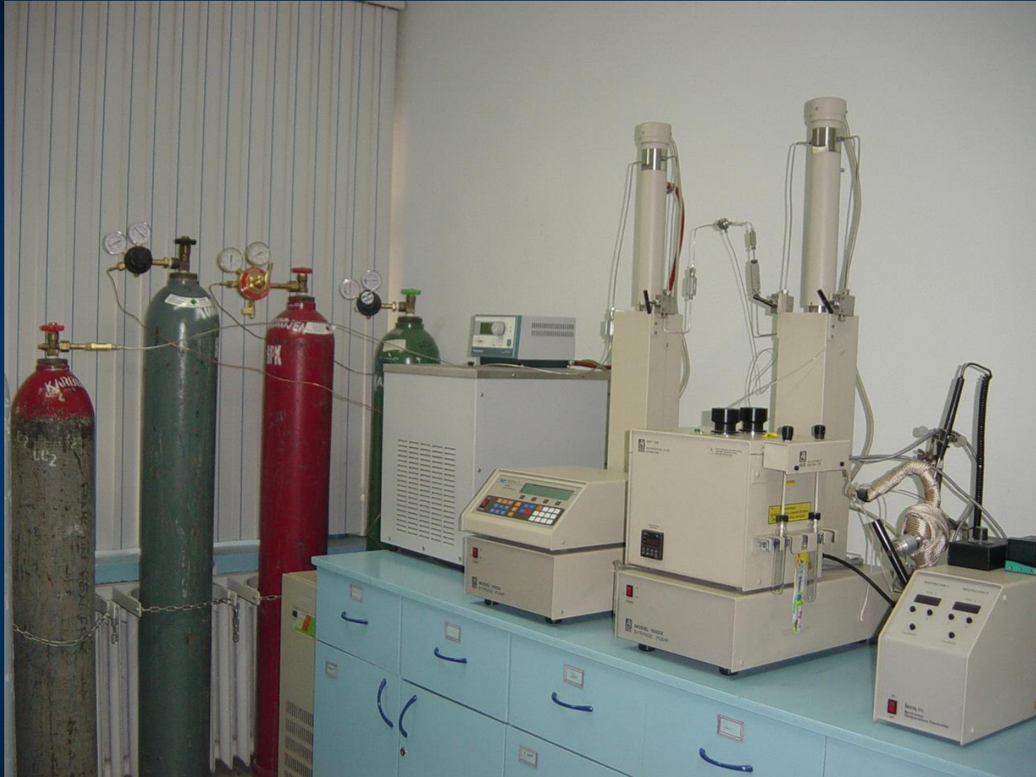
ISCO-Sitec modifiye SFX 220 süperkritik akışkan ekstraksiyonu ve RESS sistemi
