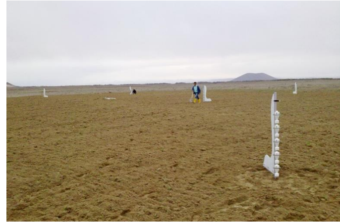
Meteoroloji istasyonu ve BEST sediment tutucuların araziye yerleştirilmesi, Konya Karapınar, 2010
