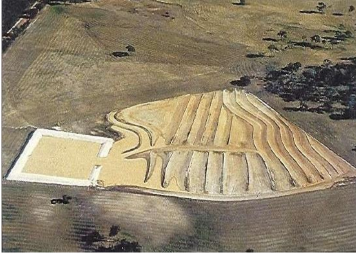
Şekil 4.13 Yüzey akışın bir rezervuarda toplandığı sıra arası sistem
