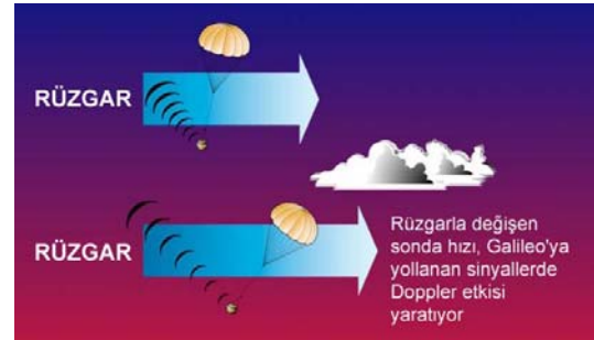
Şekil 7.16 Galileo sondası ile doppler deneyi
