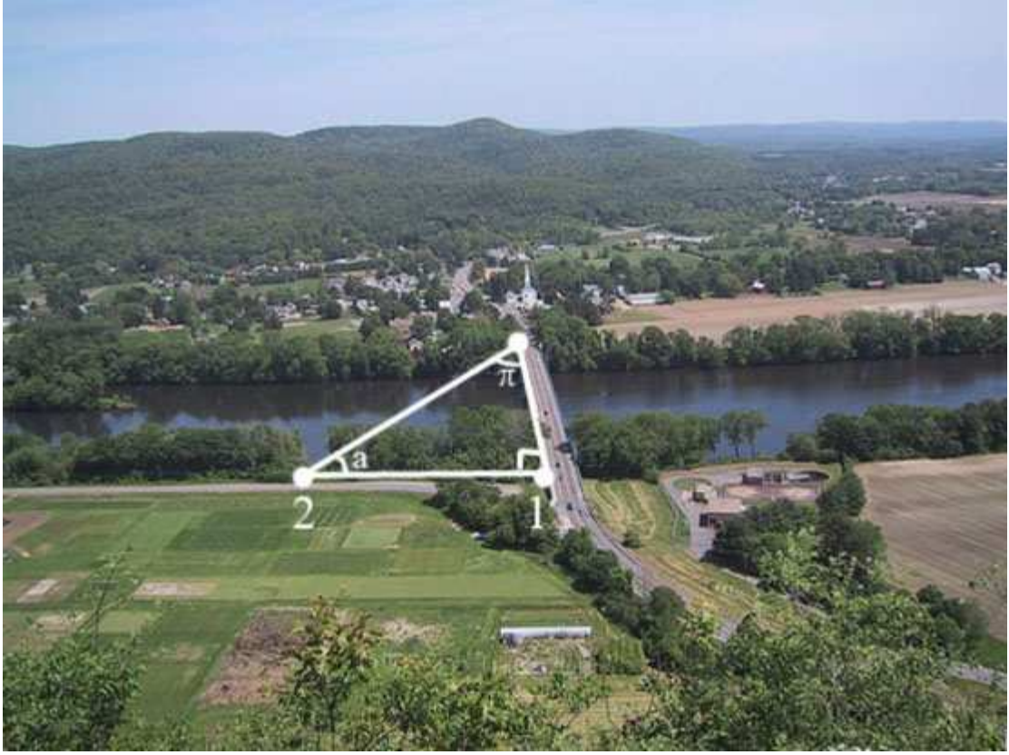
Şekil 2. Bir köprünün uzaklığının yanına gidilmeden ölçülmesi
