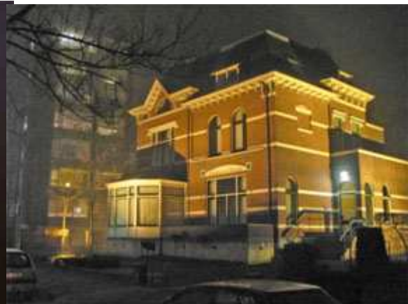
řekil 8. Yksek basınlı sodyum lambaları ile yukarı ynde aydınlatmalar. Iřınımın ođu gkyzne kamaktadır.
