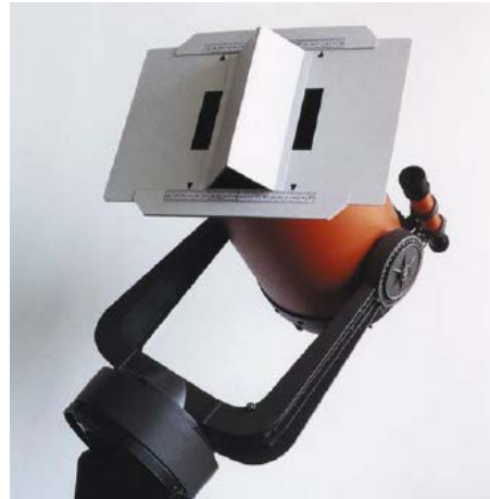
Şekil 4.40. Basit interferometrik sistem. Merceğin önüne birbirine paralel açıklığa sahip ve aralarındaki uzaklığın D olduğu bir metal plaka yerleştirilir. Tercihen D uzaklığı değiştirilebilir ve metal plaka aynı zamanda döndürülebilir olmalıdır.
