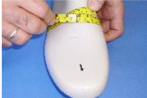
Kontrpiye çevresinin ölçülmesi
