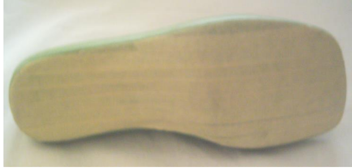
Kalıp altını boyuna bantlama
