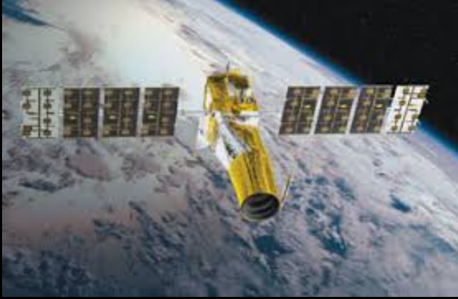
Convection, Rotation and planetary Transits (CoRoT): 27 cm'lik bir teleskop ve 4 CCD dedektörle uzaydan yürütülen proje 2006 - 2013, 45 gezegen!
