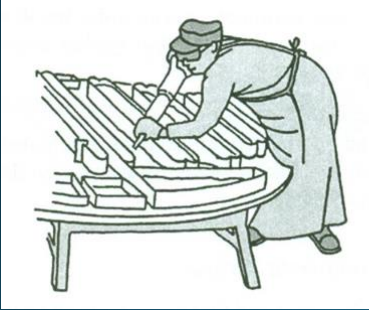
Döküm atölyesinde çapak temizlemekte olan işçinin oldukça yüksek düzeyde statik yük altında çalışması (Grandjean, 1975)
