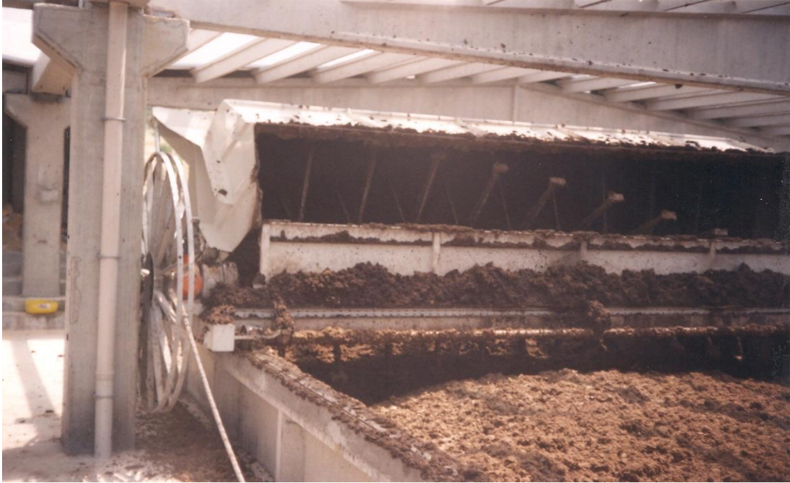
Şekil 4. Kapalı havuz sisteminde hayvan dışkılarının kompostlama havuzlarına yüklenmesi
