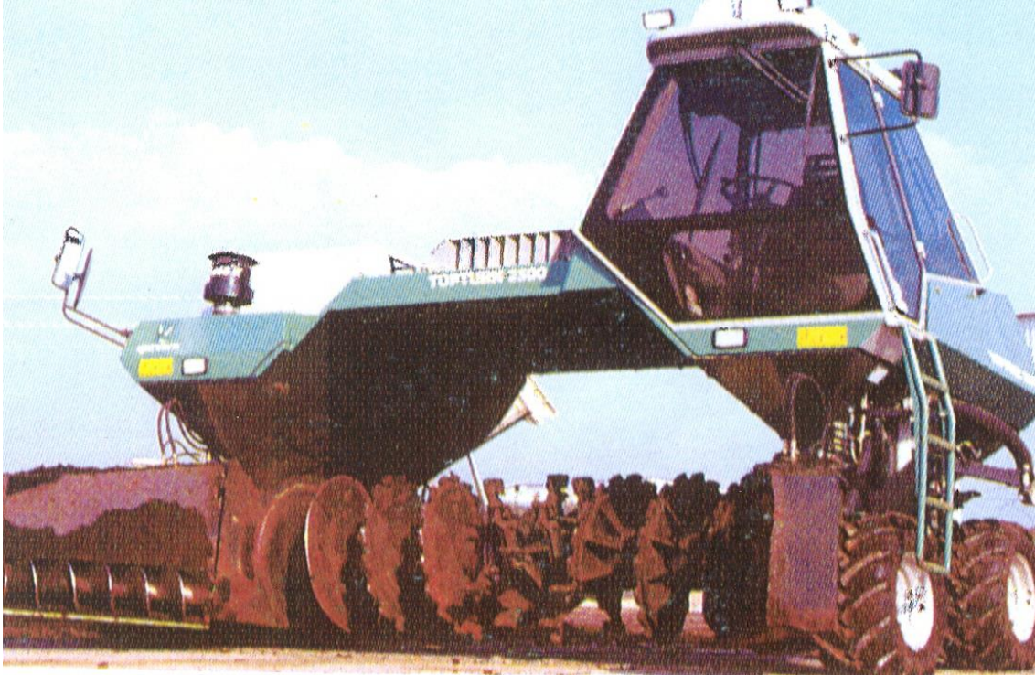
Şekil 7. Arabalı karıştırma sisteminde kullanılan karıştırma makinası
