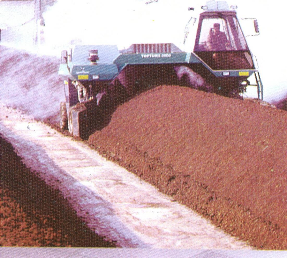
Şekil 8. Arabalı karıştırma sisteminde fermentasyon süresince dışkıların karıştırılması
