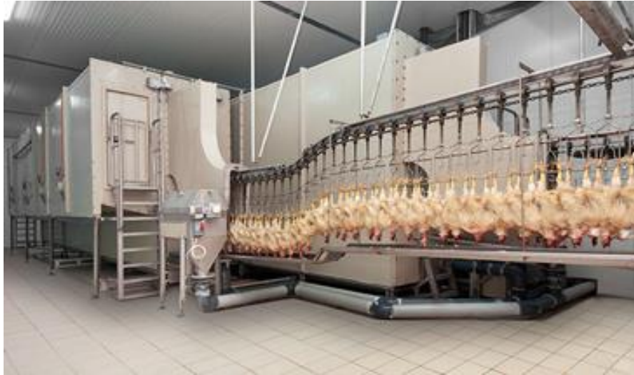
Resim: Aeroscalder (nemli sıcak hava) sistemi.
