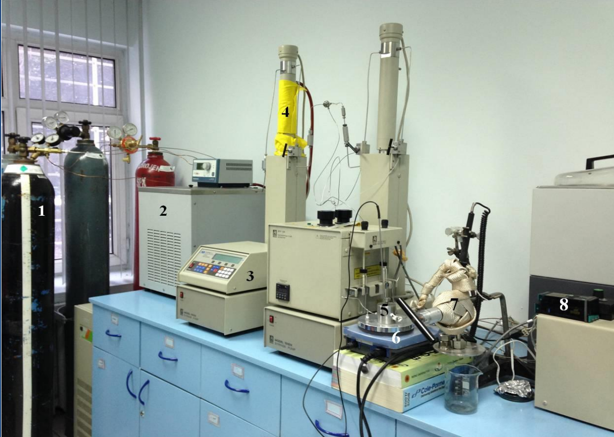
Modifiye ISCO-Sitec SFX-220 süperkritik akışkan ekstraksiyonu ve RESS sistemi CO 2 tüpü (1), Sirkülatör (2), Kontrol ünitesi (3), CO 2 pompası (4), Reaktör ünitesi (5), Mekanik ısıtıcı (6), Gaz dağıtıcı (7), Restriktör sıcaklık kontrol ünitesi (8)
