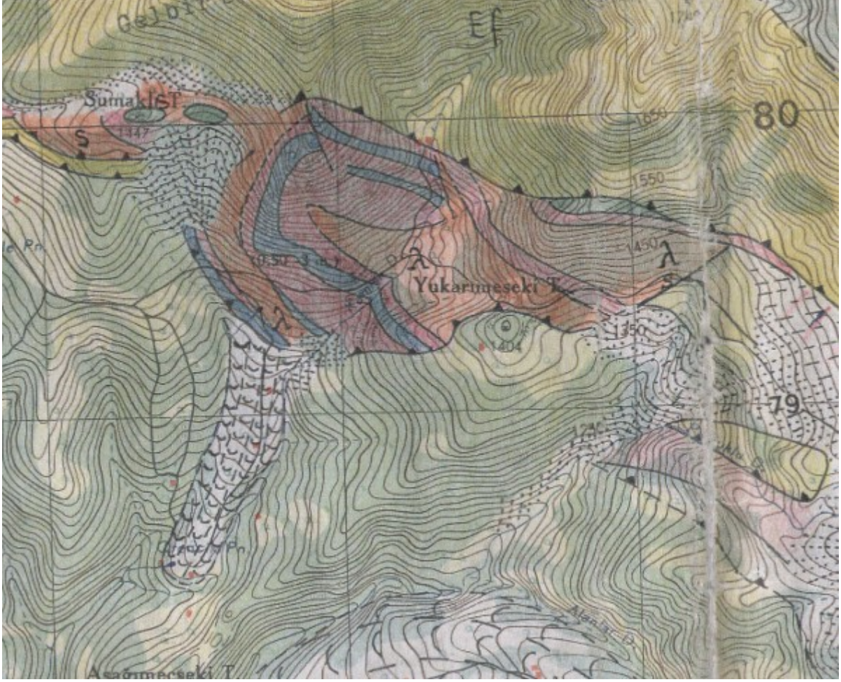
Şekil 5. Jeolojik sınırları çizilmiş 1/25.000 ölçekli topoğrafya haritası örneği (Poisson vd.)
