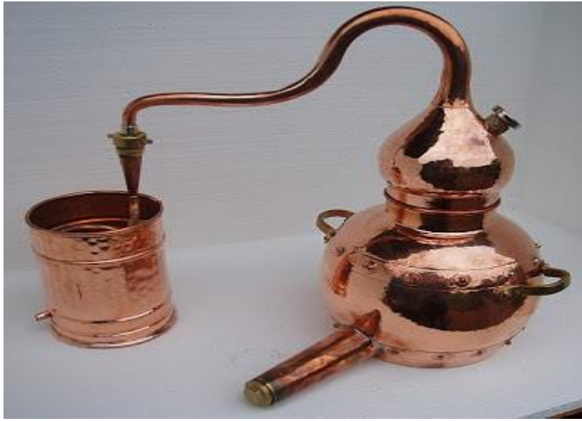
Şekil 1. Rakı damıtılmasında kullanılan geleneksel bakır imbik ( http://tadimnotlari.blogspot.com.tr/2012/07/rak-m-sarap-m.html )
