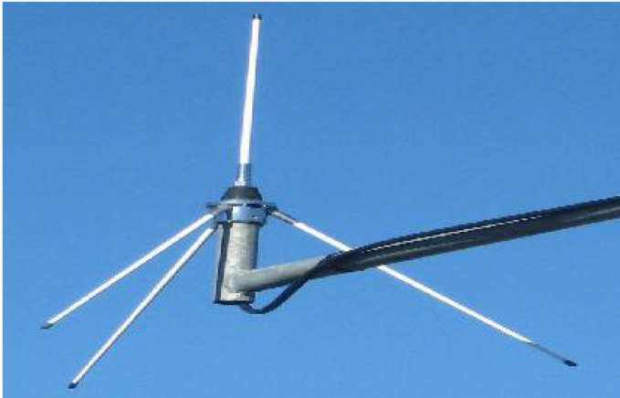
(b) Bir monopol anten (alttaki üç metal çubuk toprak plakası olarak görevi yapıyor)
