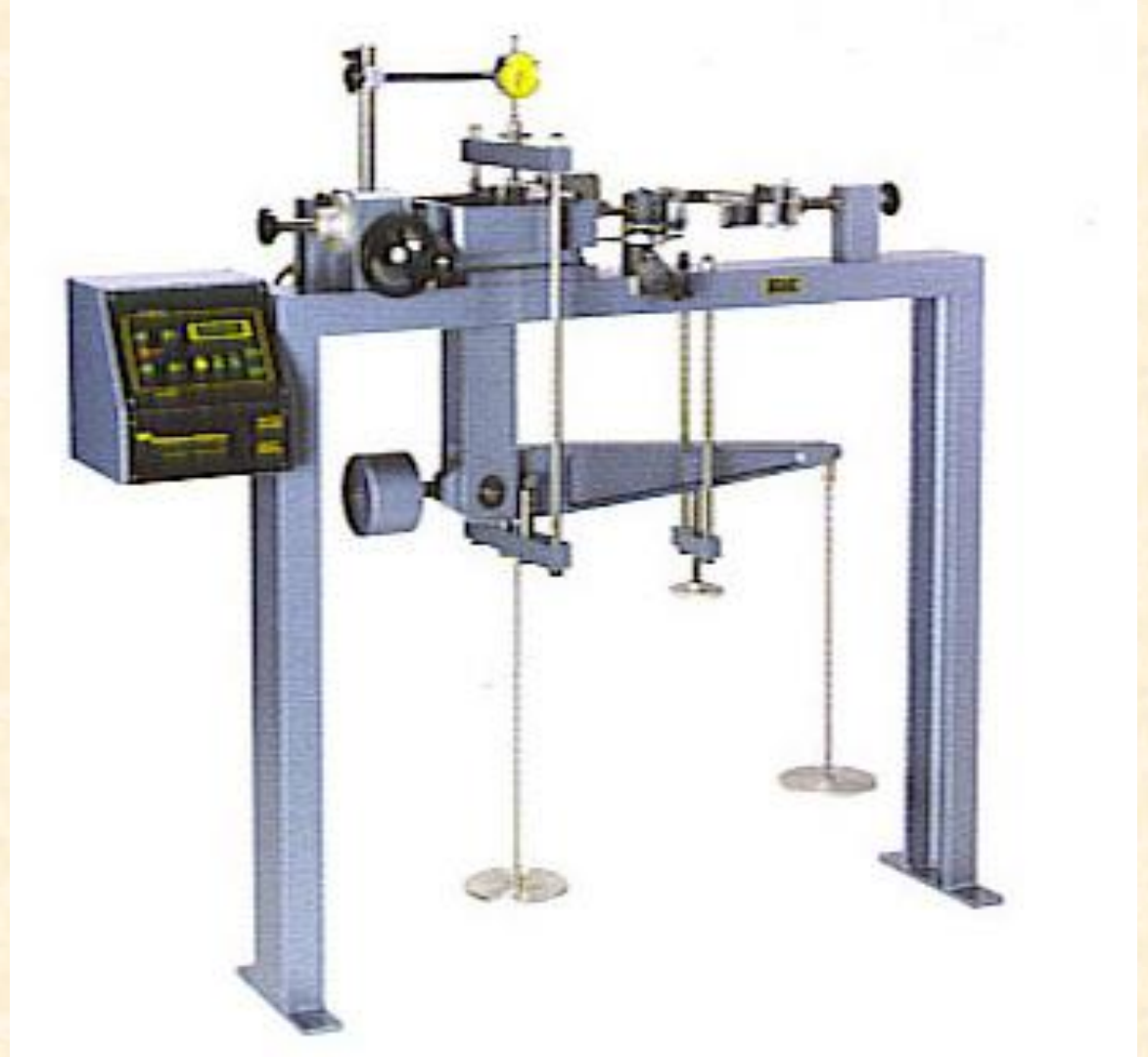
Őekil 17.12 Direk makaslama deney aleti
