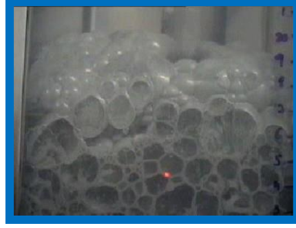
Şekil 11. Froth kararlılığı deneyi
