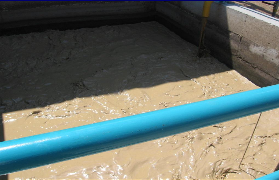
Şekil. Biyogaz elde edilmesi için organik atığın hazırlanması
