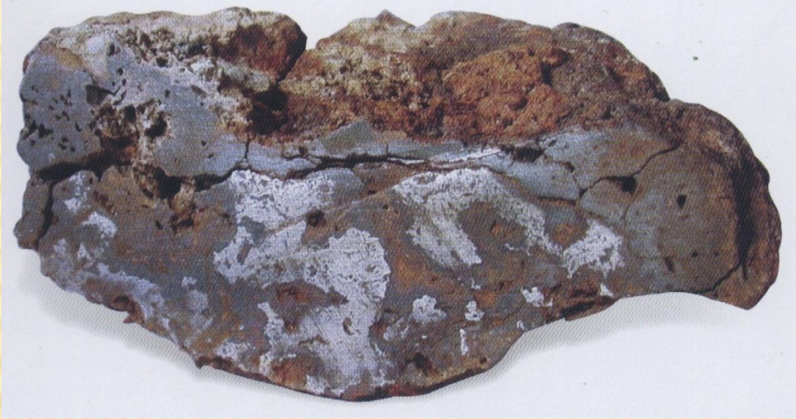
Anad-Dok-Bes Renn fırınında elde edilmiş Luppe (curuf demir ) s222
